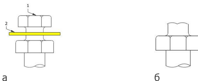
Рис. 6 Болт со срывной головкой: а – до монтажа; б – после монтажа; 1 – срывная головка болта; 2 – цветная бирка.
