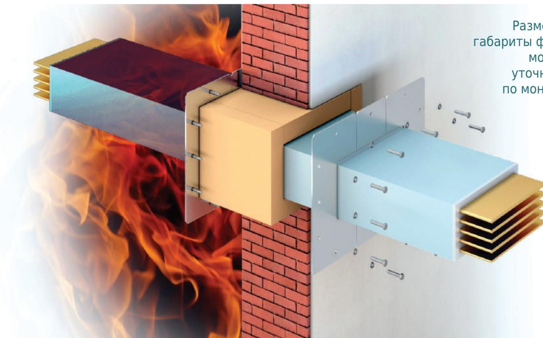
Размеры проема в стене, габариты фланца и положение монтажных отверстий уточняйте в руководстве по монтажу шинпровода.
