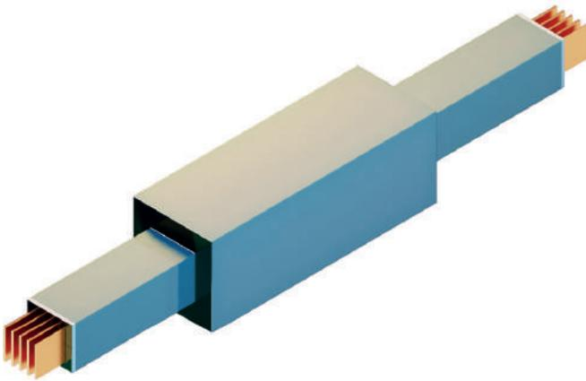
Секция термокомпенсации 1500 мм используется для компенсации теплового расширения. Как правило, устанавливается на прямых участках более 30 м. На участках свыше 60 м устанавливаются две, свыше 90 м три и т.д.
