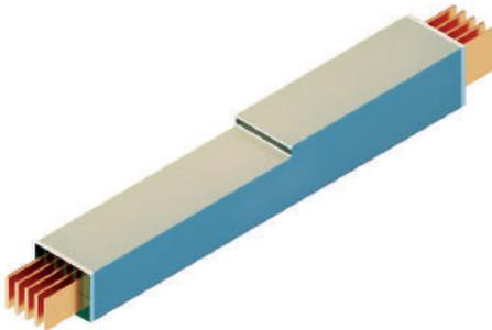
Секция понижающая 1500 мм используется для уменьшения сечения шин, питающих конечного потребителя. Такой подход позволяет сэкономить средства, обеспечивая оптимальное распределение электроэнергии. Возможно изготовление секций понижающих с защитой менее мощного участка линии (автоматическим выключателем, расцепителем, плавкой вставкой)
