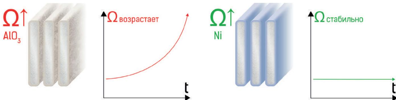
Оксид алюминия образуется и растет на поверхности проводника с момента производства
